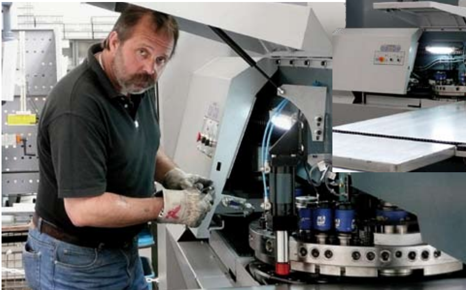
An die Durma TP6, eine hydraulische Revolverstanzmaschine, legt Unternehmer Bernd Kampmann auch mal selbst Hand an; er kann sich seinen Betrieb ohne die TP6 heute nicht mehr vorstellen.
