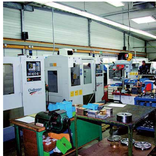
Mit sechs Challenger Werkzeugmaschinen in der mechanischen Fertigung werden Werkstückserien zwischen 10 und 100 Teilen produziert.
