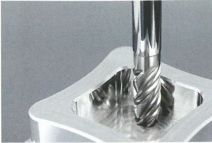
Bild: Der Cut&Form-Fräser im Einsatz (Werkbild: EMUGE-Werk Richard Glimpel GmbH & Co. KG, Lauf)
