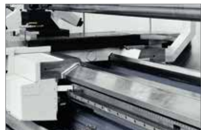
Die TUR MN Drehmaschinen werden serienmäßig mit bis zu 16 Metern Spitzenweite geliefert. Bei Maschinen mit bis zu 4 Metern Spitzenweite erfolgt der Antrieb der Z-Achse mittels Kugelumlaufspindel. Bei größeren Maschinen wird ein „Master-Slave“ System-Zahnstangenantrieb mit integriertem Messsystem verwendet.
