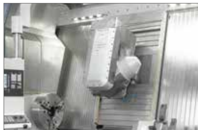
Fräskopf mit echter B-Achse (1°Hirth-Verzahnung) (Baureihe FTM).
