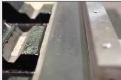
Ein hochfester, patentierter Spezialbelag erhöht die Stabilität und Präzision bei der Spanabnahme maßgeblich und sichert eine nochmals erhöhte Langlebigkeit der Führungen.
