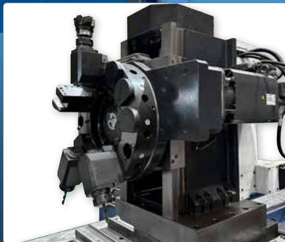
Für einen optimalen Werkzeugeinsatz, können die POWERTURN Drehmaschinen optional mit einem automatischen VDI Werkzeugrevolver bestellt werden.
