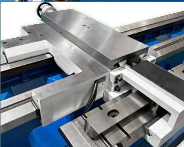
Die Aufbauweise des **Oberschlittens / Support** mit breiten Überhängen, ist für Langlebigkeit und höchste Genauigkeiten – auch bei hohem Spanvolumen – ausgelegt.
